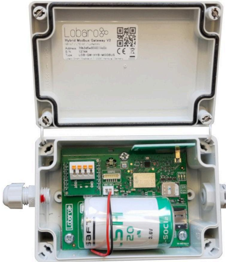
Das Lobaro Hybrid Modbus Gateway V2 mit Batterie ist für Modbus ASCII / RTU Auslesung geeignet. Der Uplink erfolgt via LoRaWAN oder via NB-IoT. Das Produkt erfüllt IP66 Anforderungen und ist für den Außeneinsatz geeignet.
